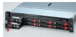
8台の3.5型ドライブに加え背面に2台の 2.5型ドライブを搭載可能 (8×3.5型ドライブモデル)
