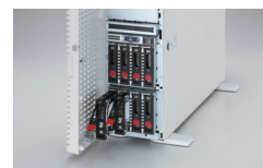
最大12台の3.5型ドライブを搭載可能 (12×3.5型ドライブモデル)
